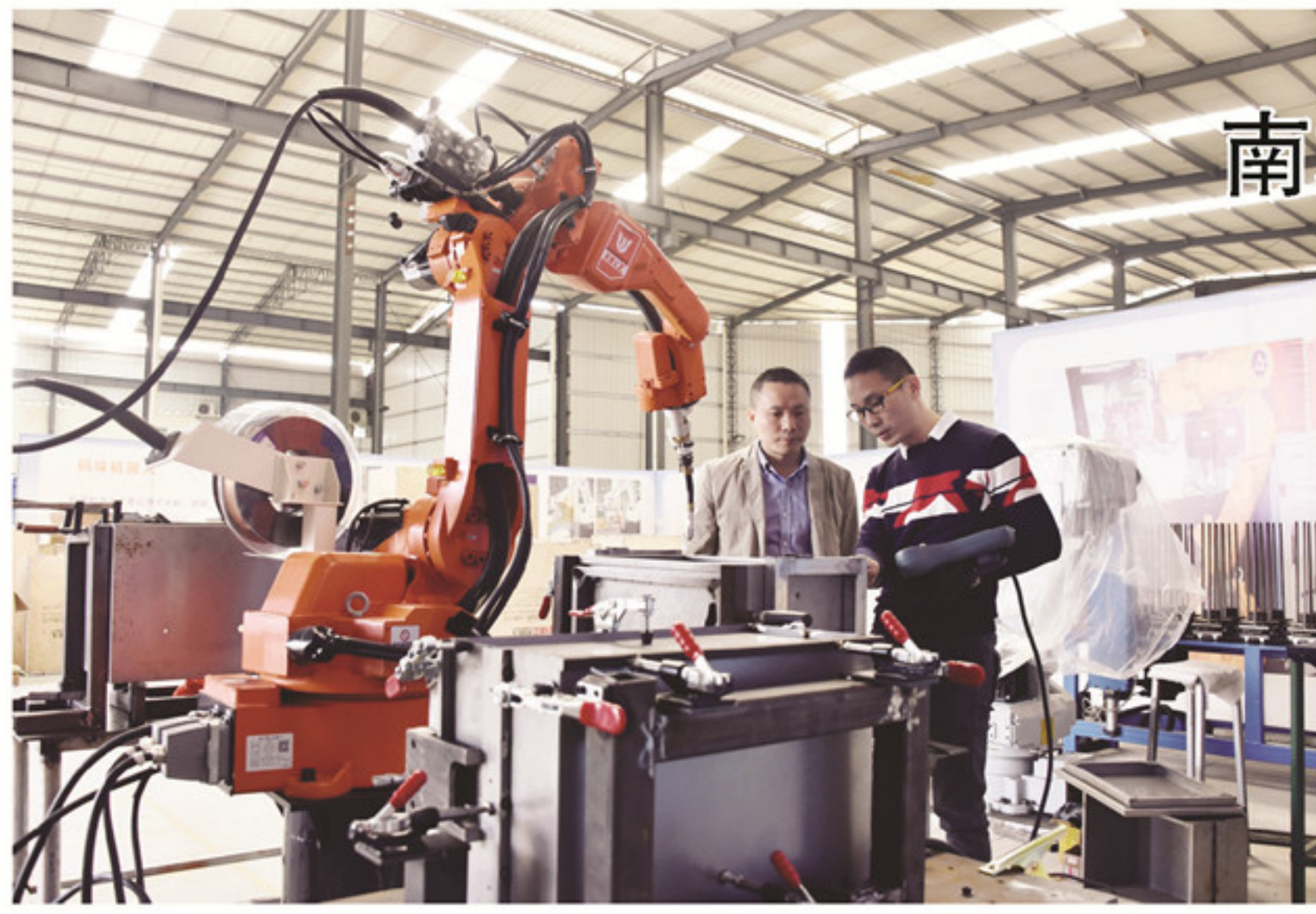
工在调试焊接机器人设备
