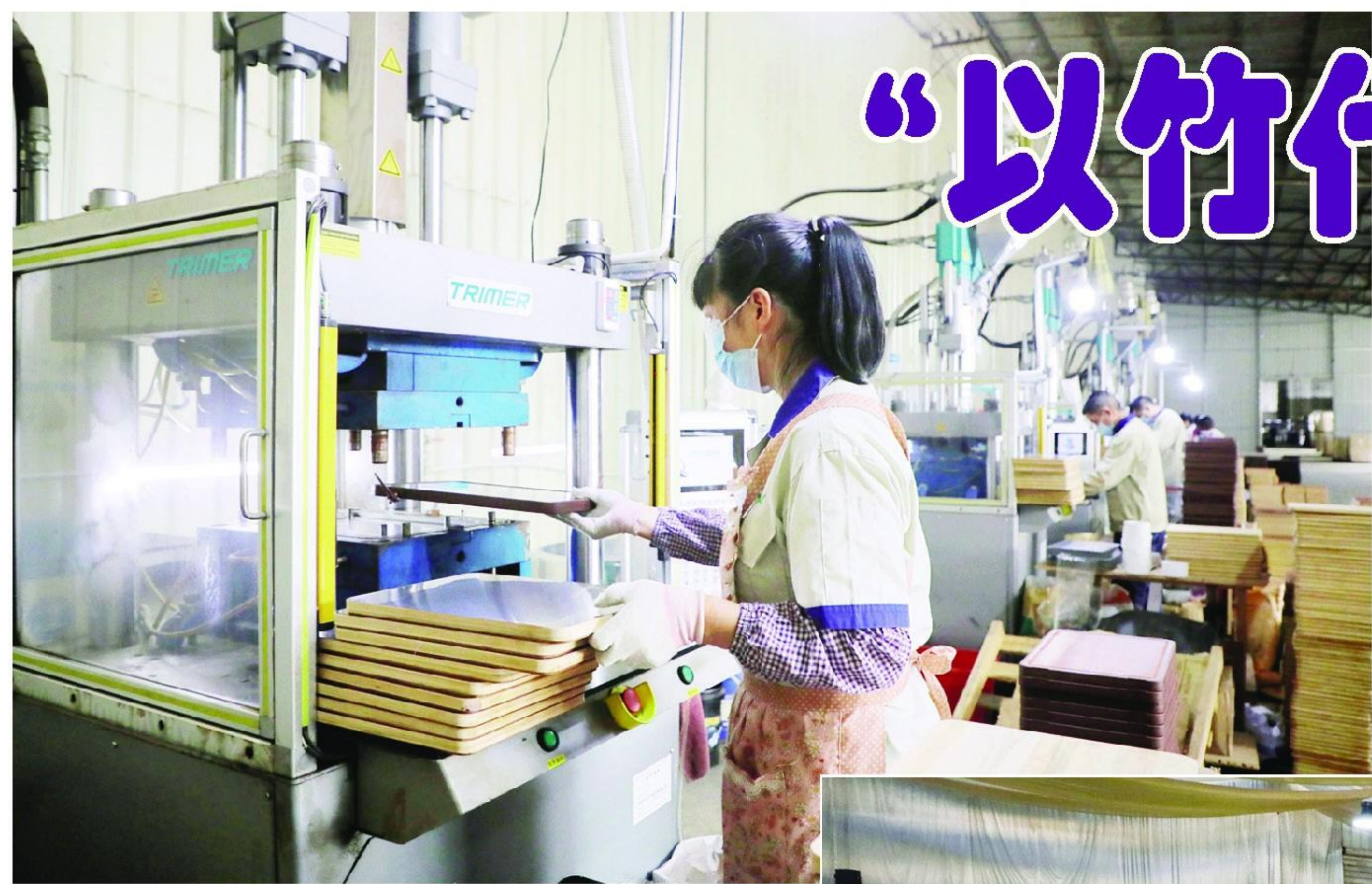
在泰和竹业有限公司生产车间,工人使用注胶机对双面砑板进行注胶。 张志伟 摄
